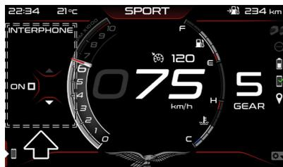
Successivamente sarà possibile controllare il livello del volume riprodotto utilizzando i pulsanti **MODE UP** e **MODE DOWN**, premendoli a lungo.
