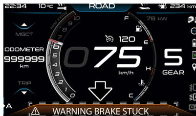
Se la pressione viene mantenuta per più di 60 secondi, con veicolo in movimento a velocità uguale o maggiore di 10 Km/h (6mph):
