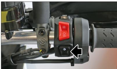
Una volta disattivato l'area pop-up si colorerà di arancione, comparirà la scritta "ABS off" e verrà visualizzata la relativa icona, ad indicare l'assenza del controllo ABS su entrambe le ruote (solo per riding mode OFF-ROAD).
