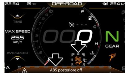
ABS disattivato (entrambe le ruote risulteranno prive di controllo ABS).
