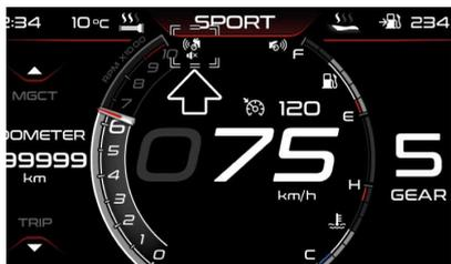
Se abilitata, questa funzione segnala la presenza di ostacoli in avvicinamento sul lato anteriore del veicolo, sia da destra che da sinistra, tramite segnali acustici e segnali luminosi sul display. In caso di oggetto in avvicinamento, con pericolo di collisione frontale, si avranno due livelli di allerta:
