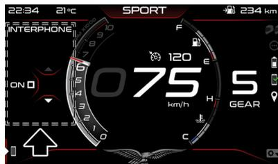
Un'ulteriore pressione breve del pulsante **MODE SET** disattiva il collegamento, visualizzando nel display digitale lo stato "INTERPHONE OFF".
