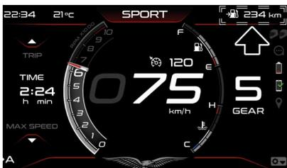
Quando il veicolo entra in riserva l'autonomia residua scompare, al suo posto verranno mostrati due trattini (- -) e nel diario di viaggio comparirà il "TRIP FUEL", il quale conteggia la distanza percorsa in riserva. Questo valore viene azzerato ogni volta che il livello della benzina, nel serbatoio, supera la soglia della riserva.
