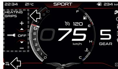
Quando il riscaldamento delle manopole viene attivato si attiva la relativa icona sul cruscotto, la quale mostra anche il livello di intensità del riscaldamento selezionato.
