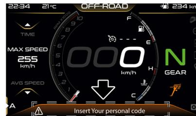
Inserito correttamente il codice, sarà visibile la schermata con l'errore rilevato. E' possibile quindi avviare il motociclo per recarsi al più presto presso un Concessionario Ufficiale **Moto Guzzi**.
