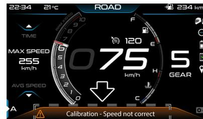
Per calibrare il sistema MGCT (Moto Guzzi Controllo Trazione), percorrere per circa 10 secondi un tratto di strada piano e rettilineo, in seconda marcia alla velocità di 40 +/- 2 km/h (24.85 +/- 1.24 mph) fino a che nel display digitale apparirà un messaggio con scritto "Calibration - Hold speed".
