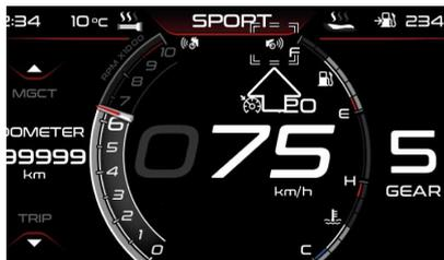
Se attiva, questa funzione segnala la presenza di ostacoli in avvicinamento dal lato posteriore del veicolo, sia destro che sinistro, tramite segnali luminosi sul display e sul relativo specchietto retrovisore.
