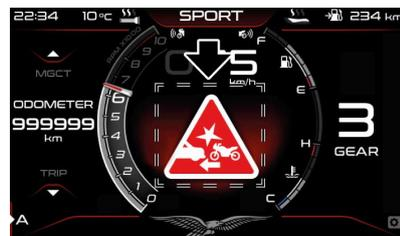
In caso di malfunzionamento del radar anteriore, l'area pop-up del cruscotto si
