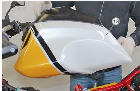
**SERBATOIO TAPPO SERBATOIO RIMOZIONE**
