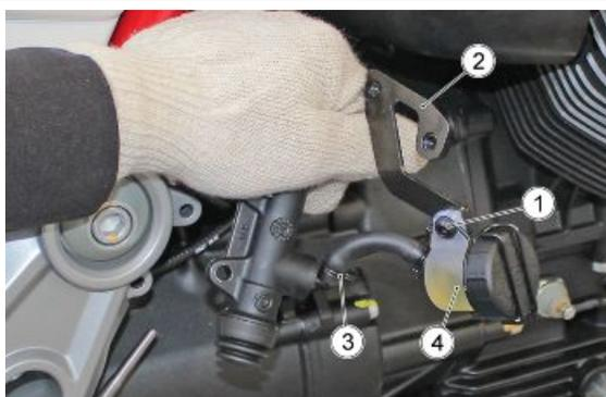
**RIMOZIONE pompa freni posteriore PLUNGER**
