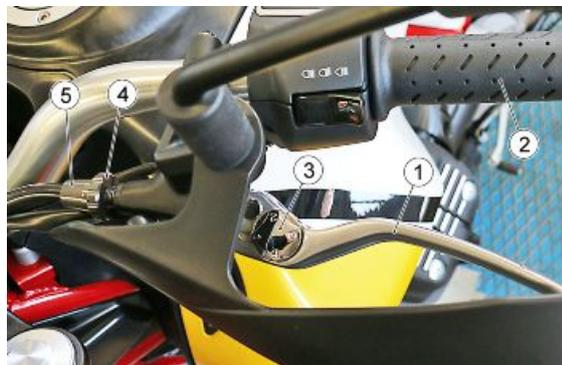
Regolare la frizione quando il motore si arresta o il veicolo tende a muoversi in avanti anche quando si aziona la leva della frizione e la marcia inserita, o se la frizione "scivola", con conseguente ritardo di avviamento considerando i giri del motore.
