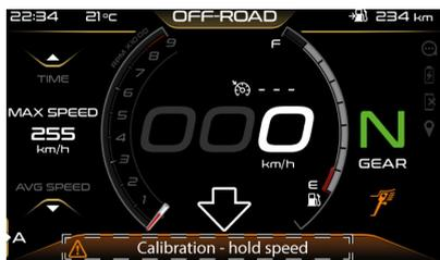
Se la calibrazione termina correttamente, sarà visibile il messaggio "Calibration done - Key OFF (60 s)".
