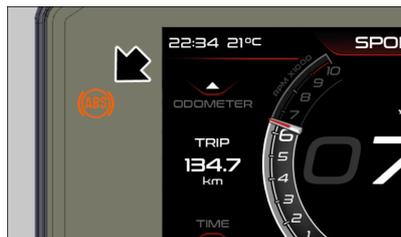
Se la spia ABS si accende in modo permanente, o continua a lampeggiare anche quando si superano i 5 km/h (3.1 mph), significa che è stato rilevato un malfunzionamento e l'ABS è stato disattivato.
