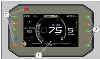
Il cruscotto è dotato di sistema immobilizer che impedisce l'avviamento nel caso in cui il sistema non identifichi una chiave che sia stata precedentemente memorizzata.
