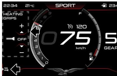
Quando il riscaldamento delle manopole viene attivato si attiva la relativa icona sul cruscotto, la quale mostra anche il livello di intensità del riscaldamento selezionato.
