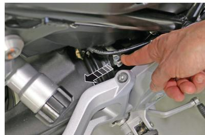
3. Spingere la leva comando frizione sita sulla scatola cambio nel verso opposto (di cui al punto 2) verificando che il cavo non sia in tensione.
