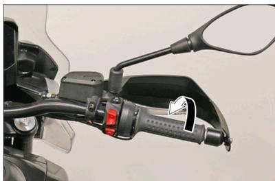
E' possibile aumentare o diminuire la velocità di crociera tramite la pressione breve (inferiore ad 1 secondo) del selettore cruise control in su o in giù (aumento/diminuzione della velocità di 2 km/h (1.24 mph)) o tramite una pressione prolungata (da 1 a 20 secondi) in su o in giù (aumento/diminuzione costante della velocità). Si può agire sull'acceleratore per aumentare temporaneamente la velocità fino ad un massimo di ulteriori 30 km/h (18.64 mph) per la terza, quarta e quinta marcia e
